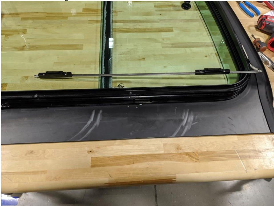
Figure 10: ER bar removed from ER track.
