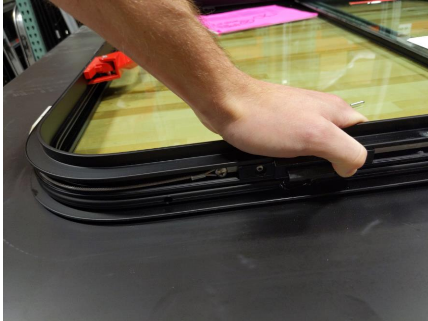
Figure 9: ER bar slid towards ER handle creating slack in ER cable.
