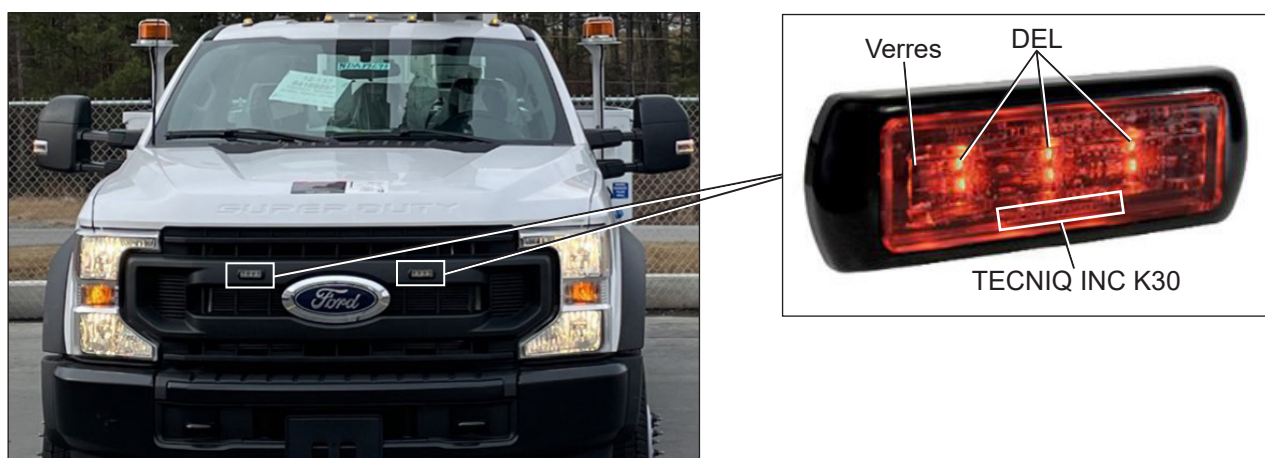
Figure 1 — Inspection des feux stroboscopiques montés en surface
