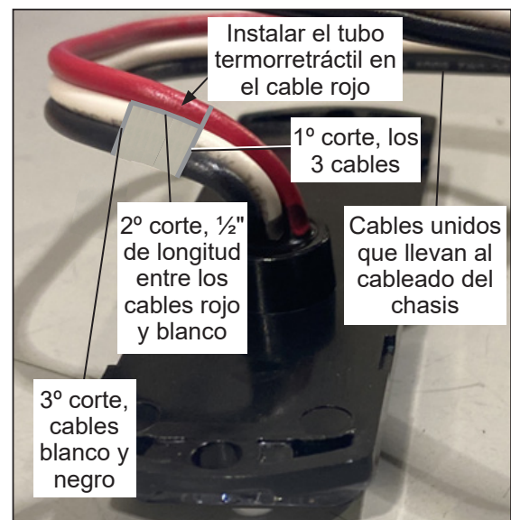
Figura 3 — Cortar cables de luces estroboscópicas
