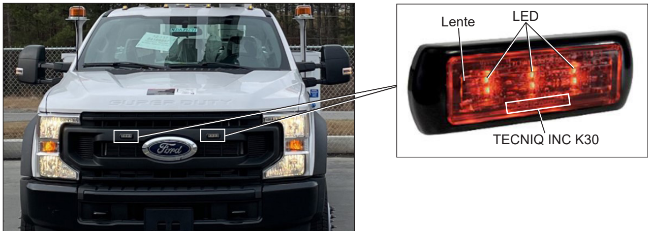
Figura 1 — Inspección de luces estroboscópicas montadas en la superficie
