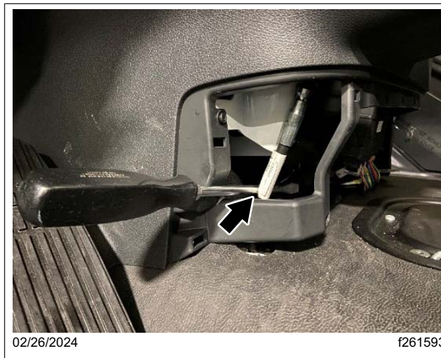
Fig. 20, Wedging the Shift Cable
