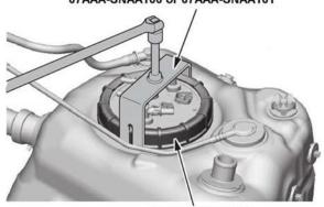
**FUEL TANK UNIT** LOCKNUT Loosen.
