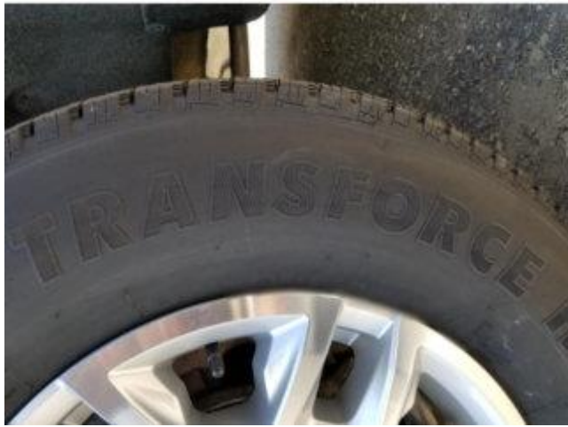
17" Firestone Transforce HT LT265/70R17 Sidewall Information
