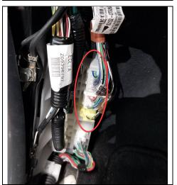
5. DISCONNECT DOOR WIRE HARNESS CONNECTOR FROM JUNCTION BLOCK
