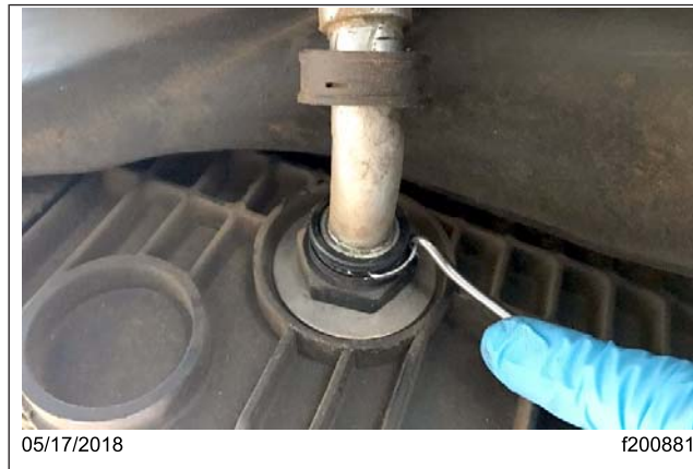
Fig. 3, Extracción del sujetador de retención
