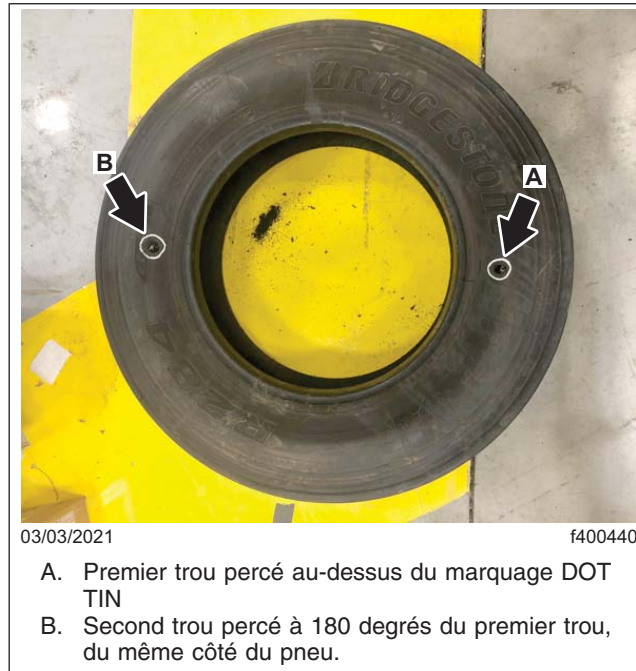
Fig. 8, Deux trous percés
