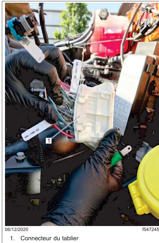
Fig. 1, Connecteur du tablier
