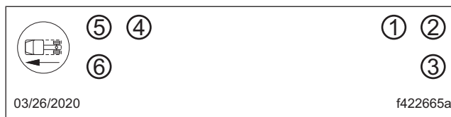
Fig. 4, Patrón de apriete, mordaza axial Bendix delantera derecha
