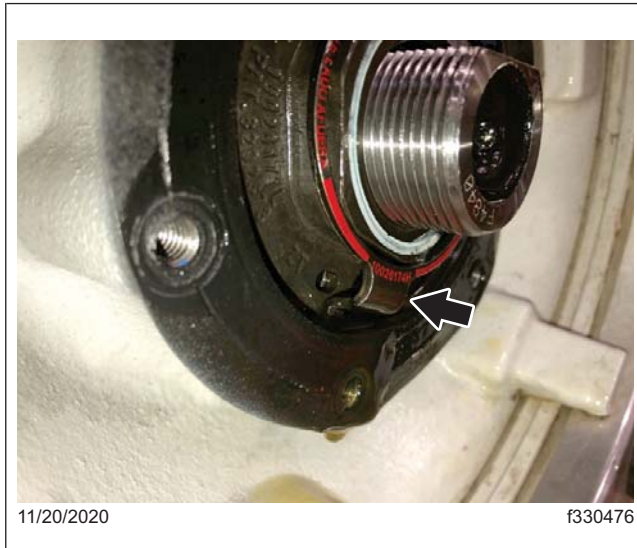
Fig. 4, La patte inférieure de l'anneau élastique n'est pas complètement installée dans le trou de verrouillage de l'écrou de fusée
