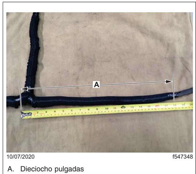
**Fig. 10, Sección horizontal de 18 pulgadas de TwistTube**
