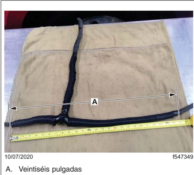
Fig. 11, Sección superior de 26 pulgadas de TwistTube
