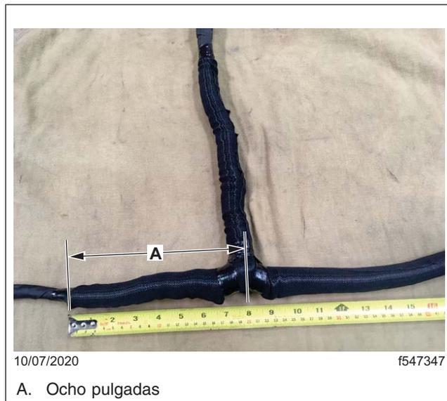
**Fig. 9, Sección horizontal de ocho pulgadas de TwistTube**
