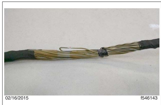
**Fig. 7, Superposición agregada al área dañada del arnés**
