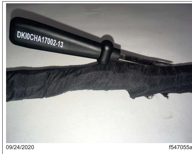
Fig. 18, Découpe de l'enrobage en fibres à l'aide de l'extrémité émoussée du découpeur
