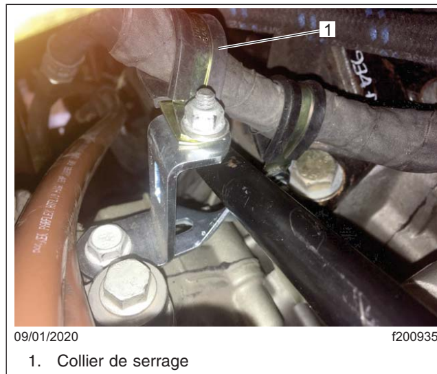
Fig. 12, Installation du collier de serrage
