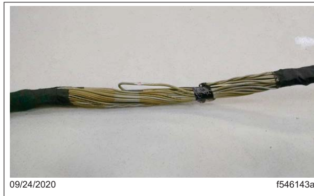
Fig. 20, Extension ajoutée à la zone endommagée d'un faisceau de câblage
