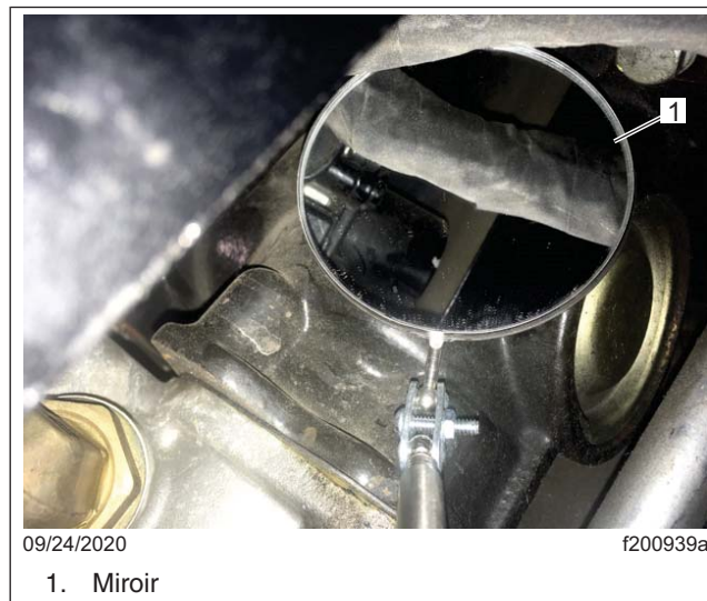
Fig. 16, Inspection avec un miroir
