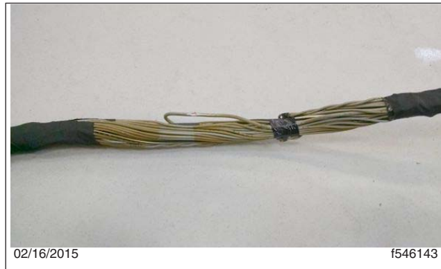
Fig. 6, Extension ajoutée à la zone endommagée d'un faisceau de câblage
