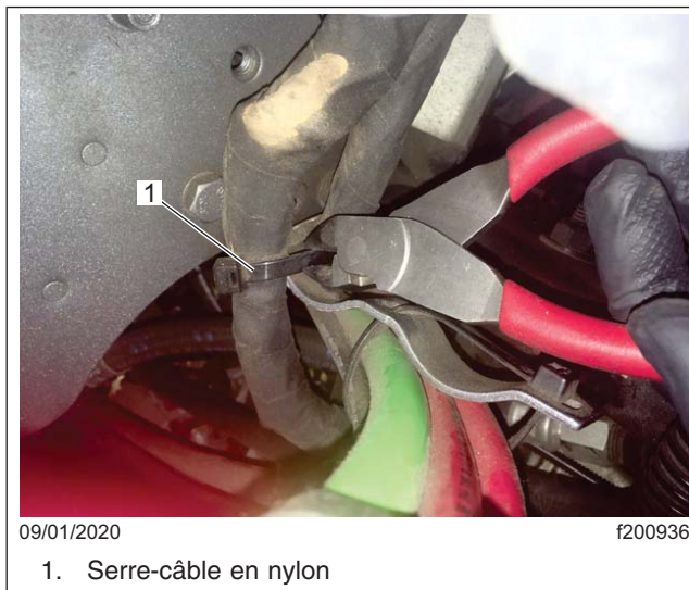
Fig. 1, Retrait d'un serre-câble en nylon du faisceau de câblage
