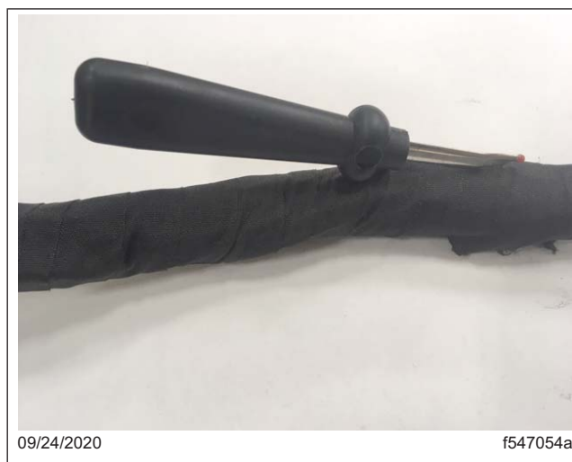
Fig. 17, Découpe d'une ouverture dans l'enrobage en fibres de verre
