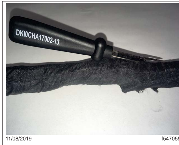
Fig. 4, Découpe de l'enrobage en fibres à l'aide de l'extrémité émoussée du découpeur
