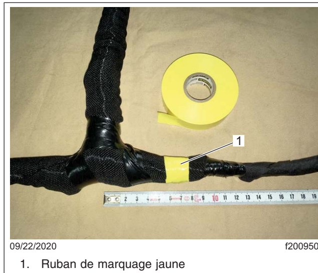
Fig. 24, Rubans de marquage jaunes pour la section horizontale
