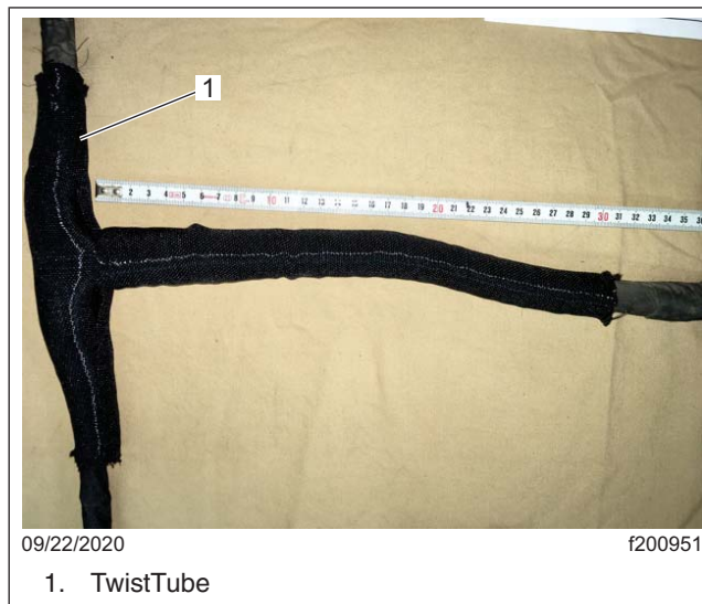
Fig. 23, Mesure verticale du TwistTube
