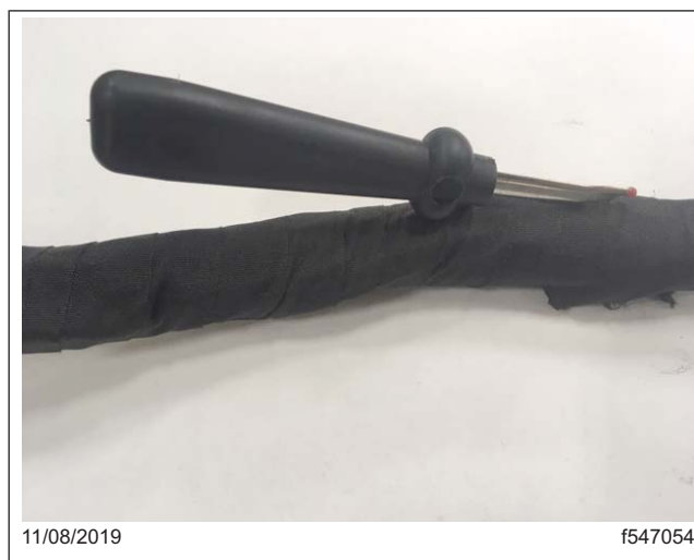
Fig. 3, Découpe d'une ouverture dans l'enrobage en fibres de verre
