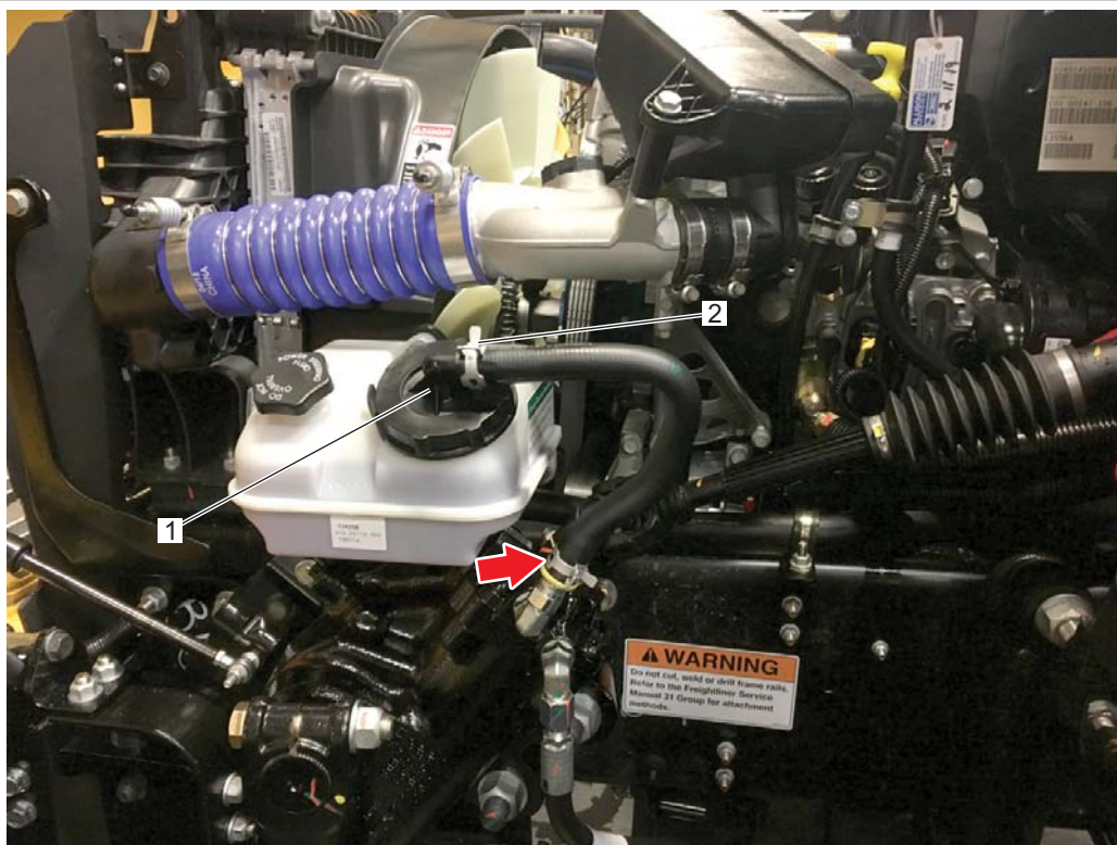
Fig. 1, Inspection du collier de serrage de la direction assistée inférieure
