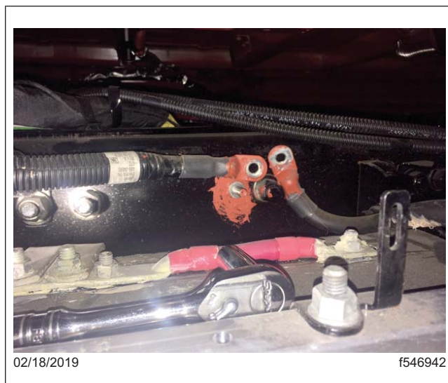
Fig. 1, GNDE Frame Rail Stud
