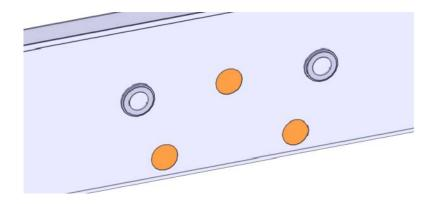
8. Install the 3 AVKs (rivet nuts 25160455).
