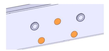
6. Install the 3 AVKs (rivet nuts 25160455).
