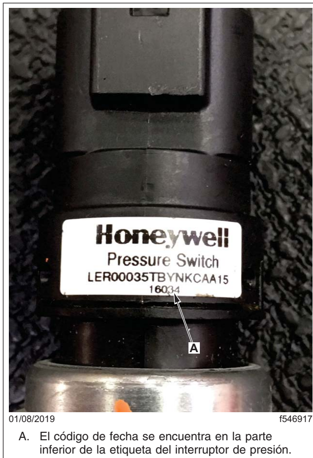
Fig. 2, Código de fecha del interruptor de presión de la luz de freno
