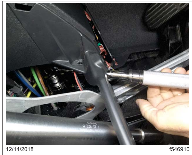
Fig. 3, Apretando el interruptor de presión de la luz de freno
