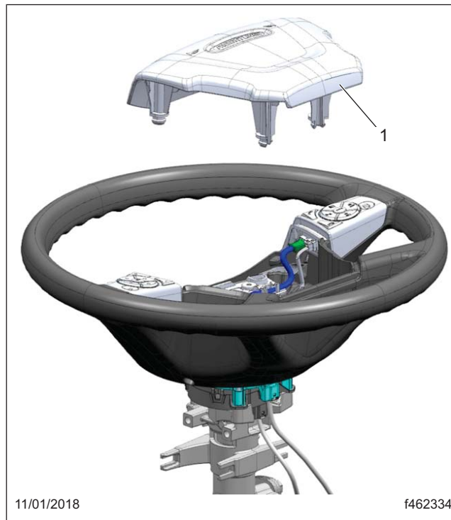
Fig. 3, Retrait du cache du volant de direction
