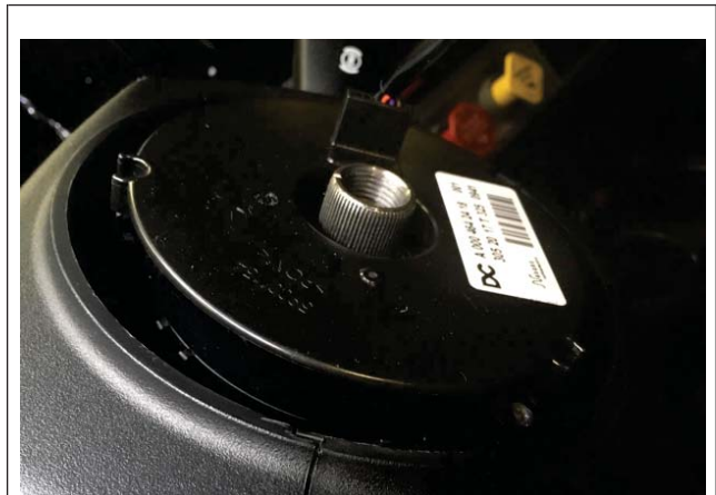
Fig. 5, Cannelures de colonne de direction avec des rainures en bon état
