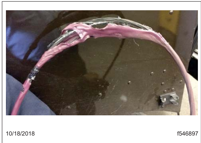
Fig. 2, Cable derretido de la palanca de cambios de la transmisión
