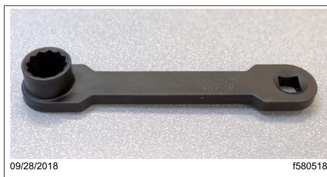
Fig. 1, Adaptador de par de apriete de la mordaza de freno de disco de aire de 30mm DDC DSNCHA018005
