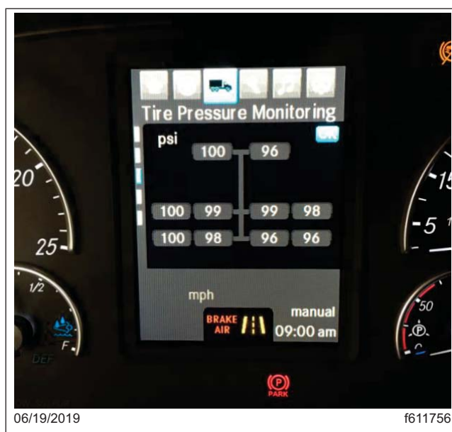
Fig. 6, Pantalla de monitoreo de presión de los neumáticos del ICUC
