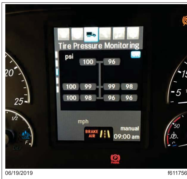
Fig. 14, Pantalla de monitoreo de presión de los neumáticos del ICUC
