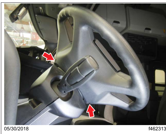
Fig. 1, Posiciones de los tornillos de retención del airbag con el volante girado 90 grados
