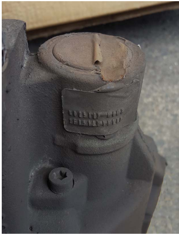
Fig. 7, Daño en la mordaza
