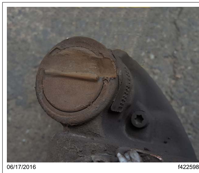
Fig. 8, Daño en la mordaza
