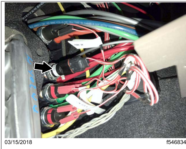
Fig. 4, Desconexión del conector del interruptor, vehículos Cascadia
