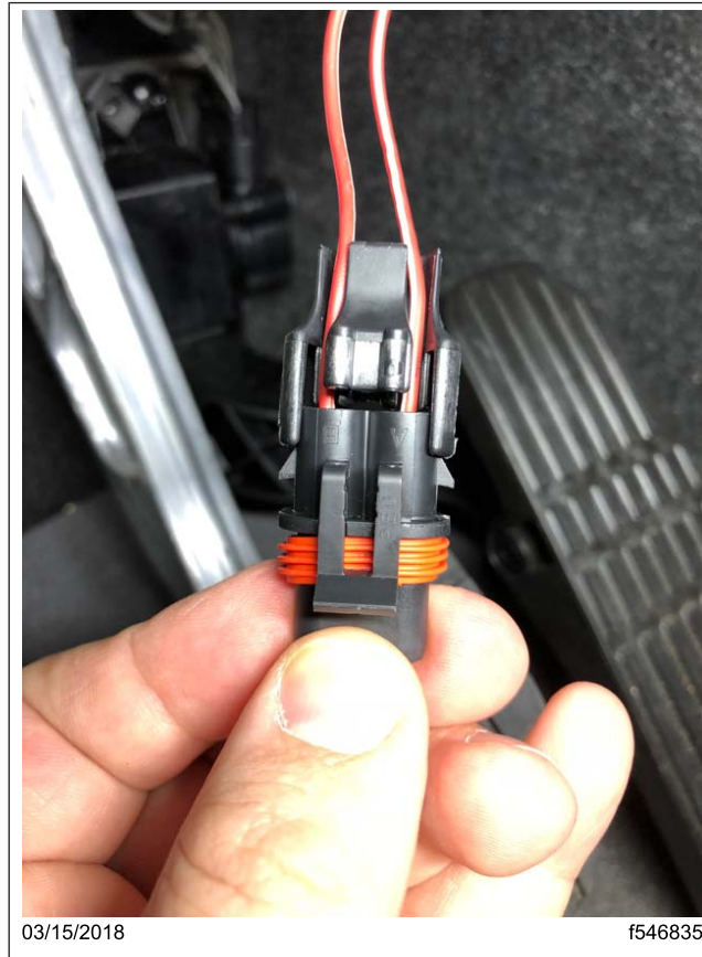
Fig. 6, Conector del interruptor, cubierta trasera parcialmente retirada
