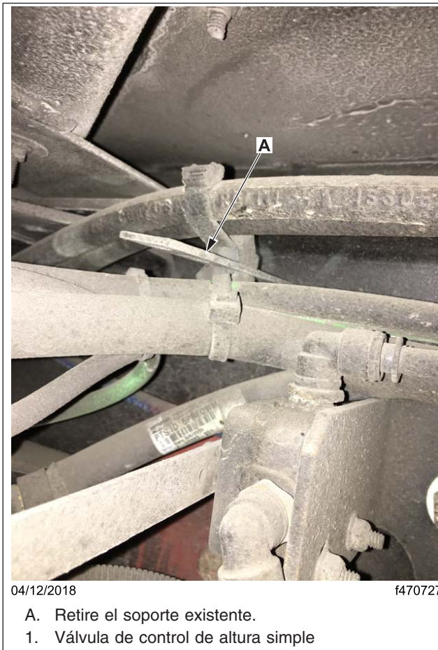
Fig. 8, Extracción del soporte
