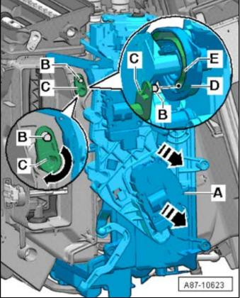
Pull the right heater core housing <A>
