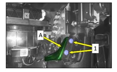
Install bracket <A> (if equipped) and torque bolts <1> to 9 Nm.
