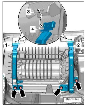
Install air guide channel <A> and torque bolts
