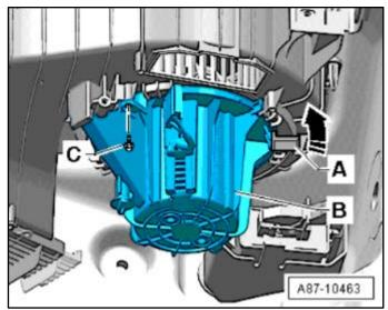
Position air intake housing <A> onto the mounts <arrows>
