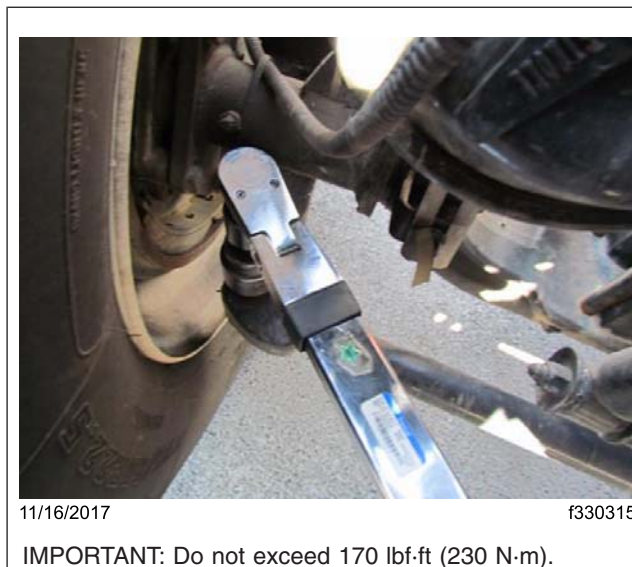
Fig. 4, Check Nut Torque
