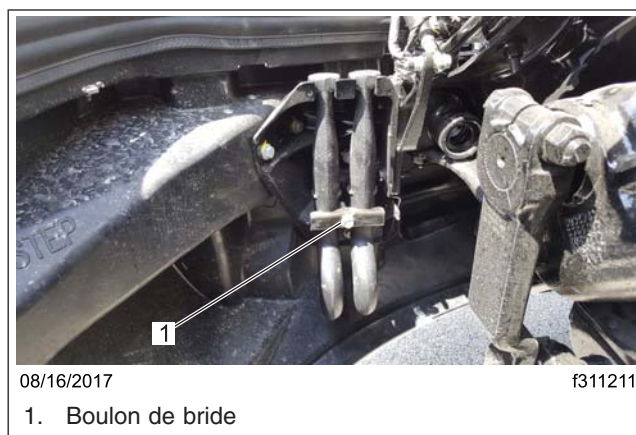
Fig. 1, Retrait du boulon de bride du crochet de remorquage
