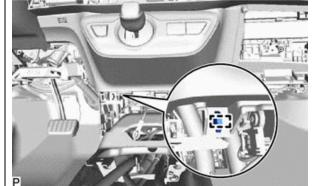
c) Disengage the clamp.
