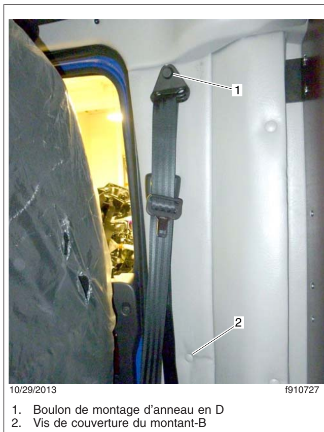
Fig. 6, Installation de la ceinture de sécurité
