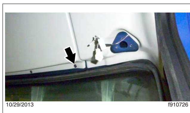
Fig. 4, Tornillo de la consola superior
