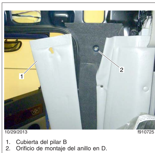
Fig. 7, Cubierta del pilar B, suelta
