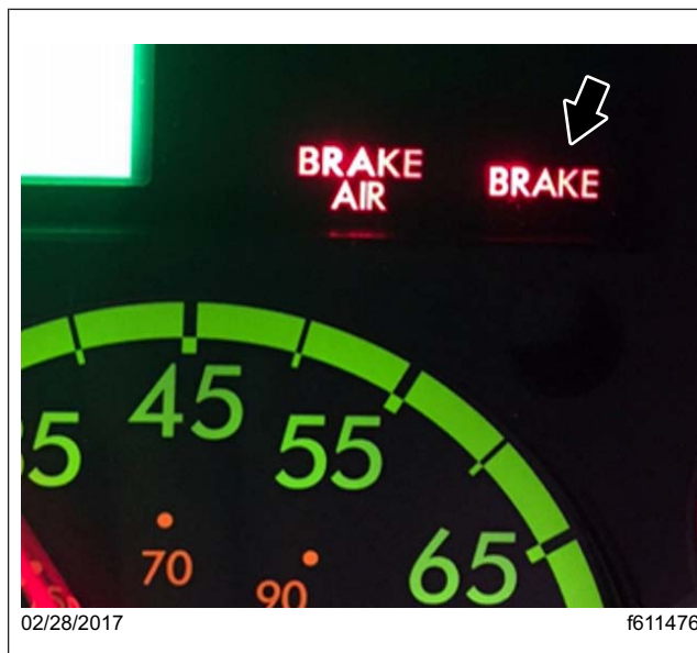
Fig. 2, Témoin « BRAKE » - Pas de remplacement nécessaire
