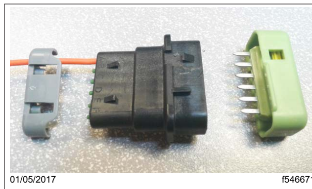
Fig. 11, Couvercle et verrouillage du connecteur-répartiteur (déposés)
