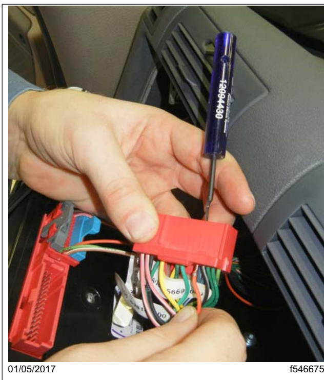
Fig. 15, Retrait du fil de la cavité D12 du connecteur 2A de l'ICU
