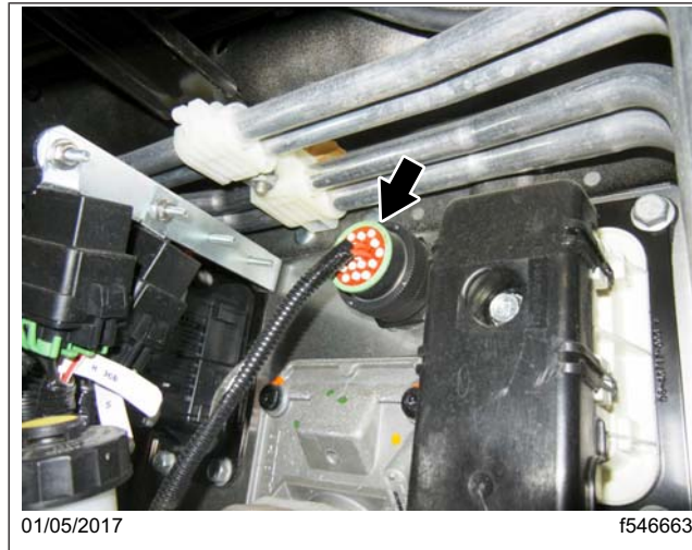
Fig. 1, Connecteur du tablier
