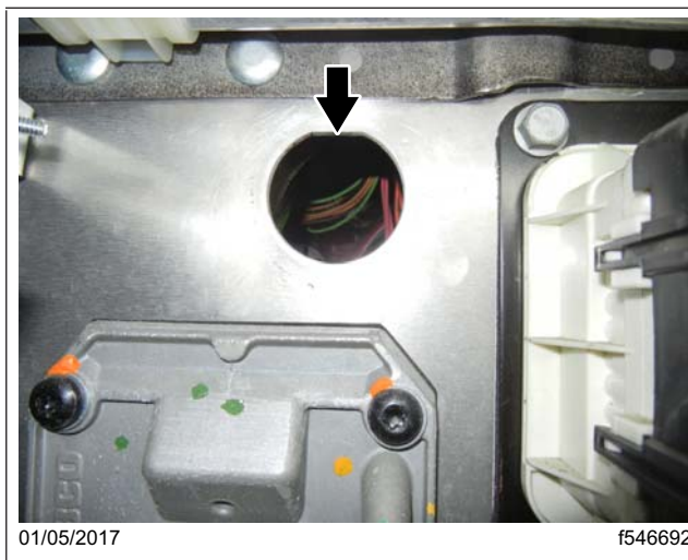
Fig. 32, Trou pour connecteur 1A pratiqué dans le tablier de la paroi avant
