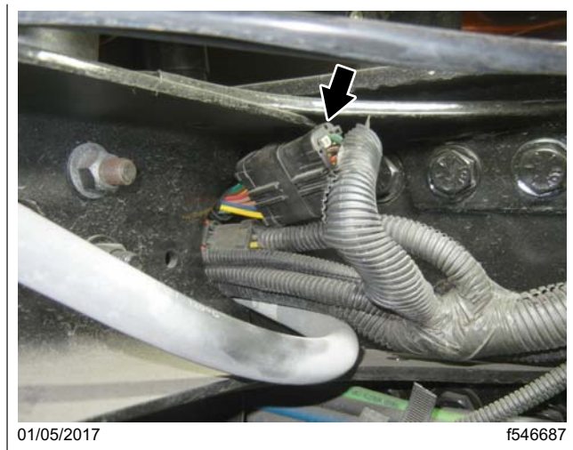
Fig. 27, Connecteur du faisceau de câblage du module CPDM
