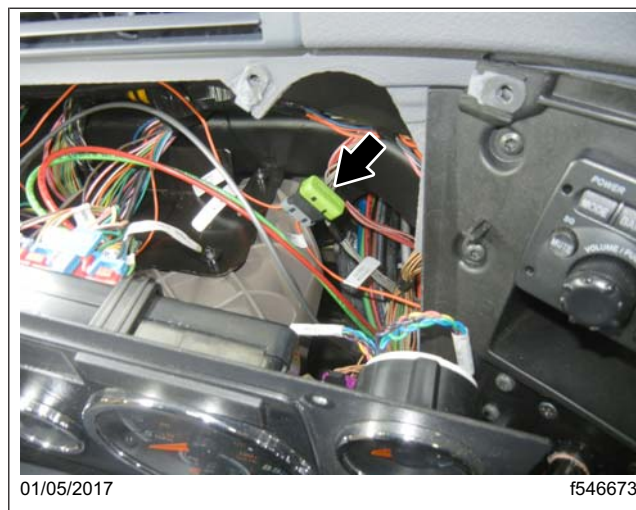
Fig. 13, Acheminement du connecteur-répartiteur
