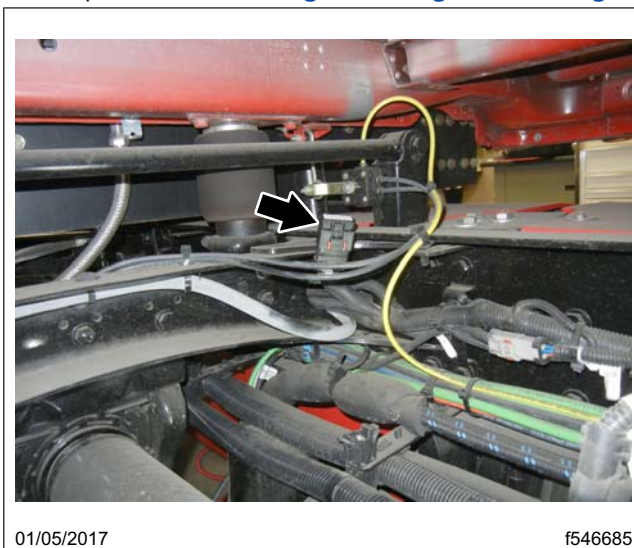
Fig. 25, Faisceau de câblage du module CPDM obturé
