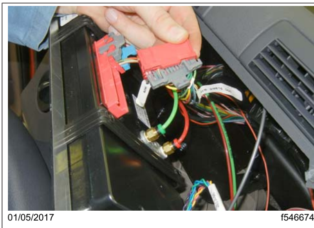
Fig. 14, Verrous de borne du connecteur 2A de l'ICU
