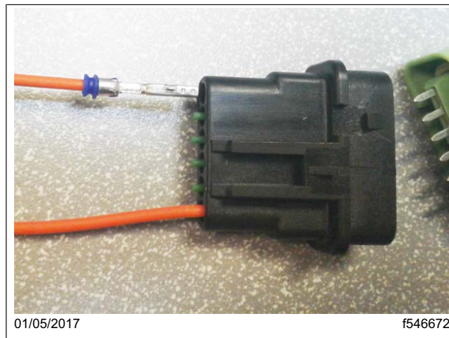
Fig. 12, Insertion des bornes du connecteur-répartiteur
