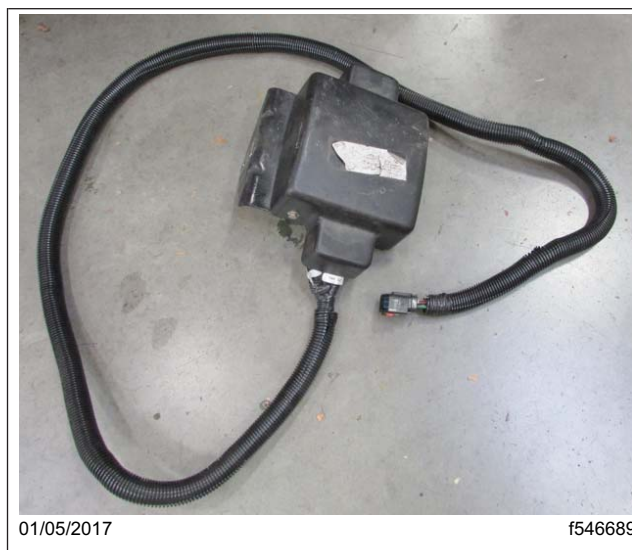
Fig. 29, Module CPDM retiré du véhicule
