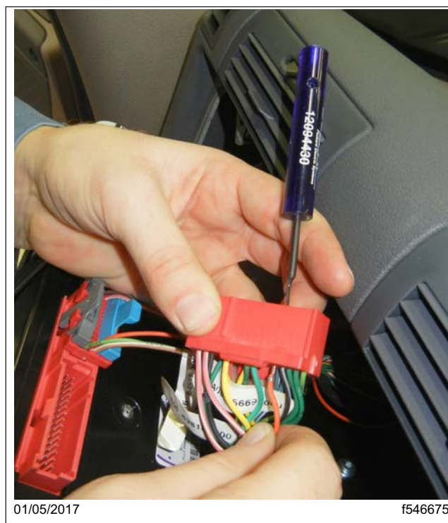
Fig. 15, Retiro del cable de la cavidad D12 del conector 2A de la ICU
