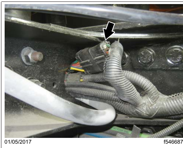
Fig. 27, Conector del arnés del CPDM
