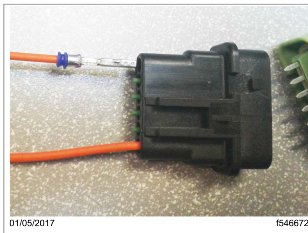
Fig. 12, Inserción del terminal en la caja de empalmes
