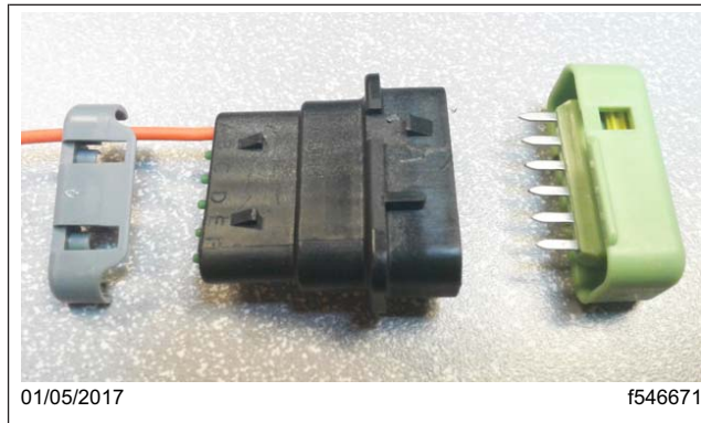
Fig. 11, Cubierta de la caja de empalmes y traba (retirada)
