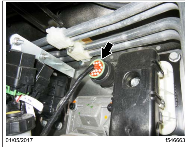
Fig. 1, Conector del tabique divisorio
