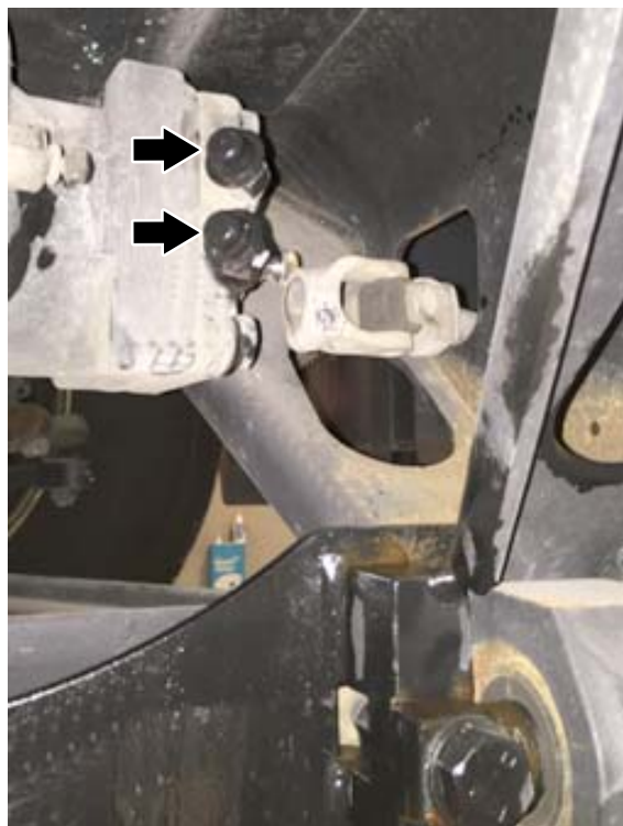
Fig. 6, Raccords de flexibles hydrauliques bouchés
