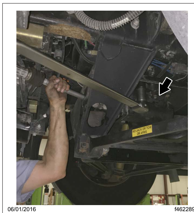
Fig. 15, Placement du boîtier de direction (le boîtier est caché par le châssis en A)
