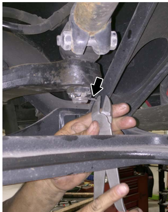
Fig. 19, Installation des goupilles fendues.
