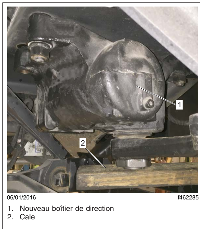
Fig. 14, Installation du nouveau boîtier de direction
