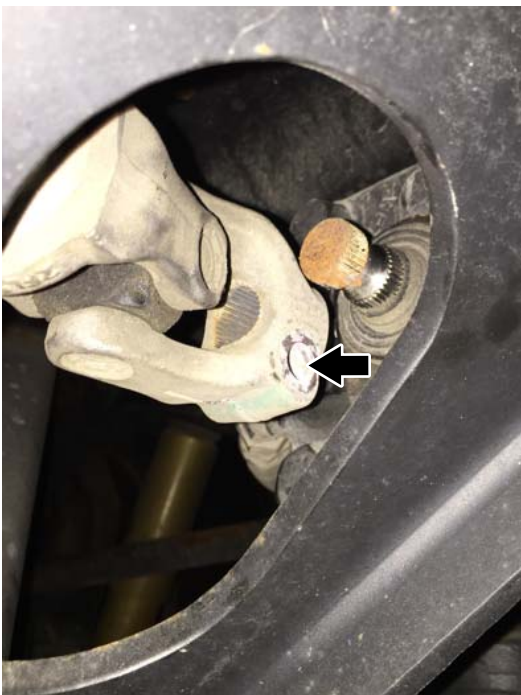
Fig. 8, Arbre intermédiaire déconnecté (boulon de bridage retiré)
