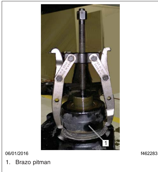
Fig. 11, Extracción del brazo pitman con un extractor de dos brazos
