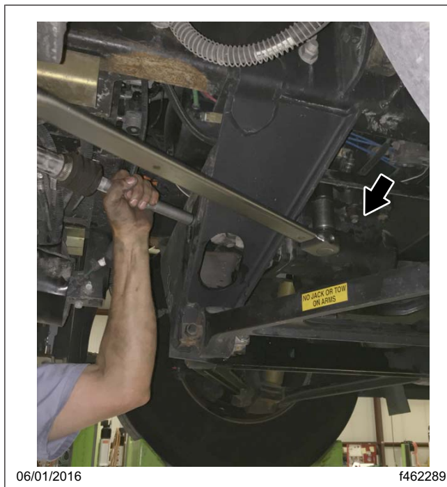
Fig. 15, Colocación del mecanismo de dirección (el bastidor A oculta el mecanismo)
