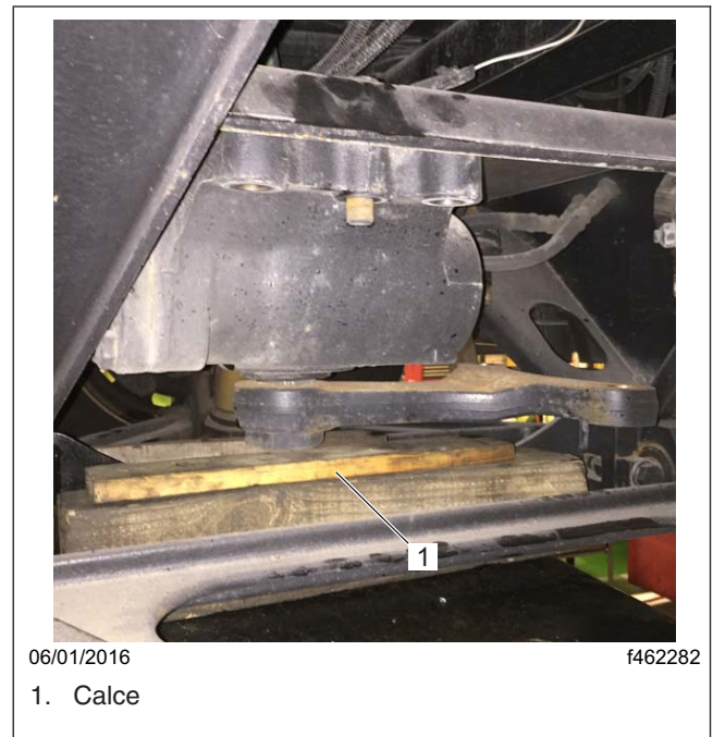
Fig. 10, Colocación de los calces
