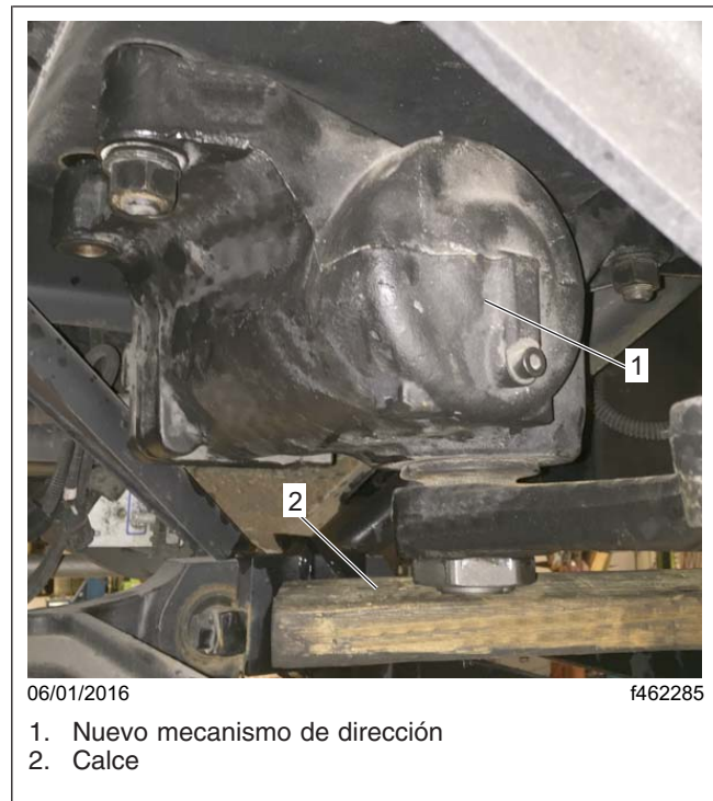
Fig. 14, Instalación del nuevo mecanismo de dirección
