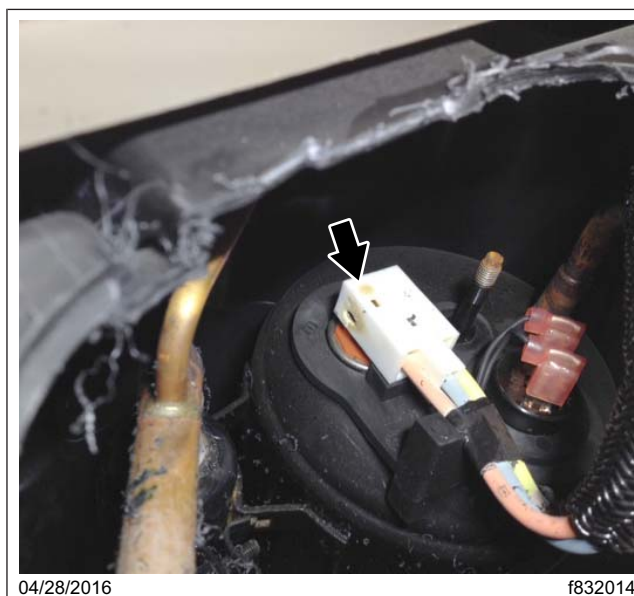
Fig. 8, Connecteur fondu et avec décoloration jaunâtre
