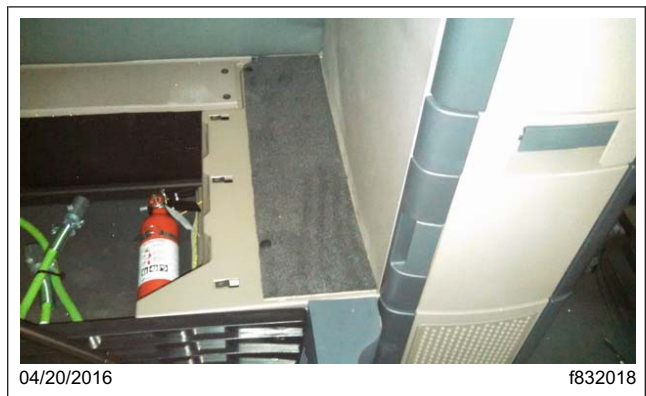
Fig. 3, Accès au compresseur dans les couchettes de 1,20 m (48 pouces) ou 1,5 m (60 pouces)
