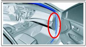
4. DISENGAGE THE FRONT PASSENGER DOOR WEATHERSTRIP
