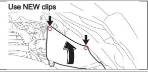
REINSTALL THE SPLASH SHEILD USING 2 NEW CLIPS
