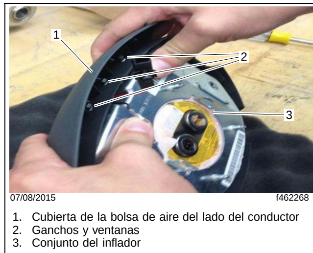
Fig. 5, Desenganche de los ganchos superiores del ensamble del inflador
