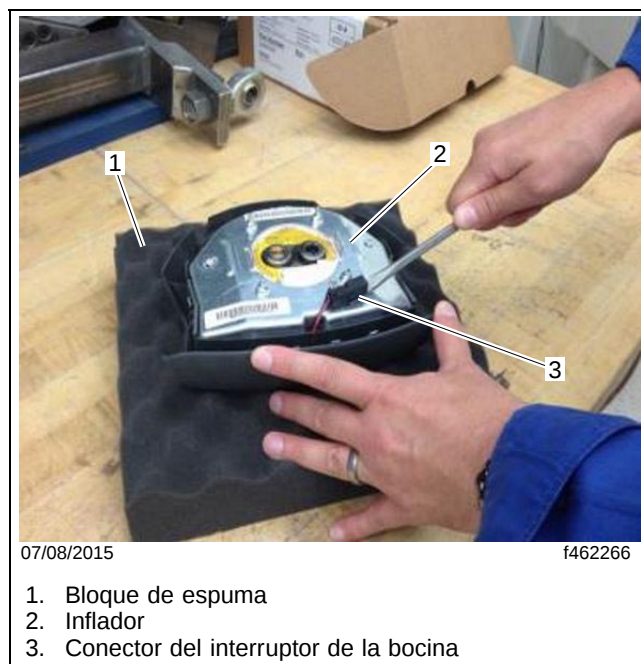
Fig. 3, Desenganche del conector del interruptor de la bocina
