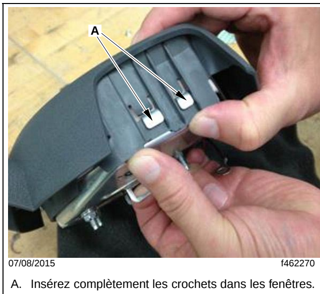
Fig. 7, Crochets de l'ensemble de gonflage
