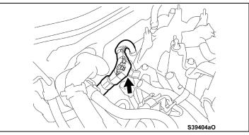
h) Disengage the clamp.
