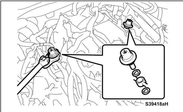
**10. REMOVE THE FUEL PRESSURE PULSATION DAMPERS**
