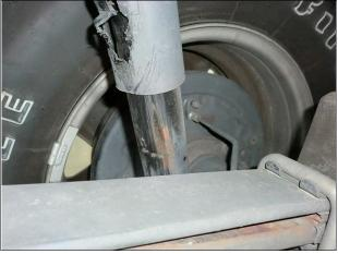
3. INSPECT THE SHOCK ABSORBER FOR DAMAGE
