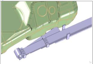
2. INSPECT THE FUEL TANK FOR DAMAGE
