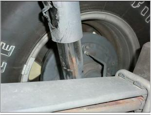
3. INSPECT THE SHOCK ABSORBER FOR DAMAGE
