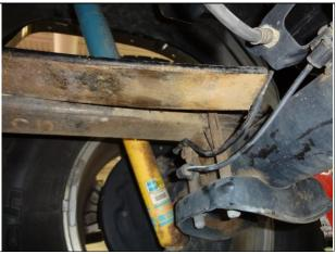
4. INSPECT THE BRAKELINE AND ABS WIREHARNESS FOR DAMAGE
