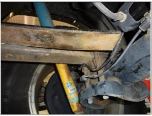
4. INSPECT THE BRAKELINE AND ABS WIREHARNESS FOR DAMAGE
