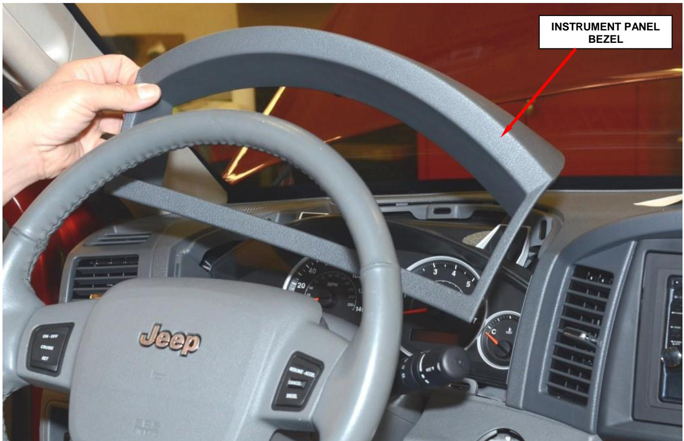
**Figure 4 – WK Instrument Panel Bezel**
