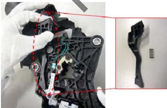
15. Remove the shift interlock solenoid.
